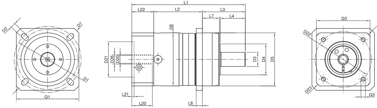
PLHE060 ile aynı özelliklerde / 1-kademeli / kamasız mil / 11 mm sıkma sistemi / motor bağlantılı – 1 parçalı / B5 motor flanş tipi
